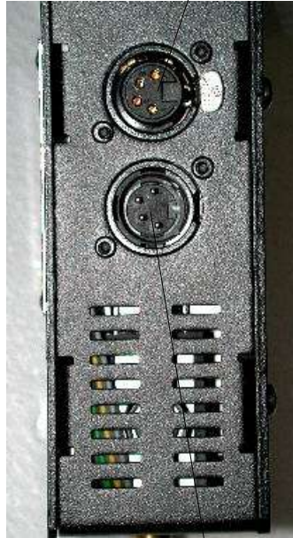
4pol Ausgang für weiteres Bag o Light System bzw. Ventilator- Anschluss zum erstmaligen Befüllen
