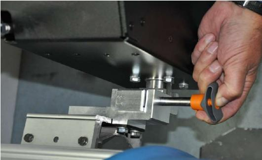
Verbinden Sie die Aufnahme des Bügels und den Lampenhalter mit dem Sicherungsstift.
