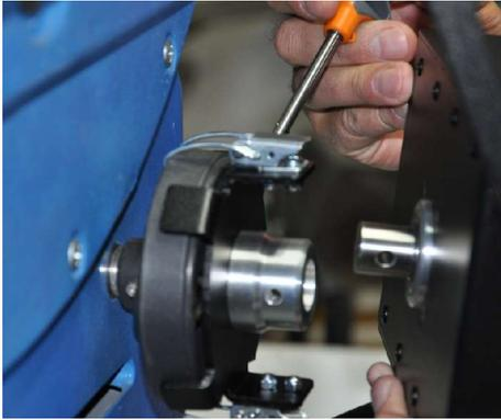
Bringen Sie die Antriebseinheit an. Sichern Sie diese mit dem Sicherungsstift
