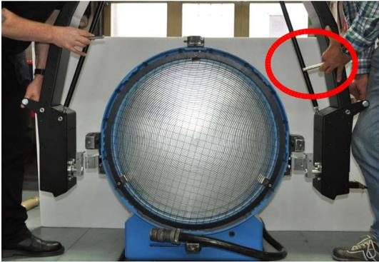
Heben Sie den Bügel über die Lampe. Lassen Sie sich helfen! Halten Sie den Sicherungsstift bereit.
