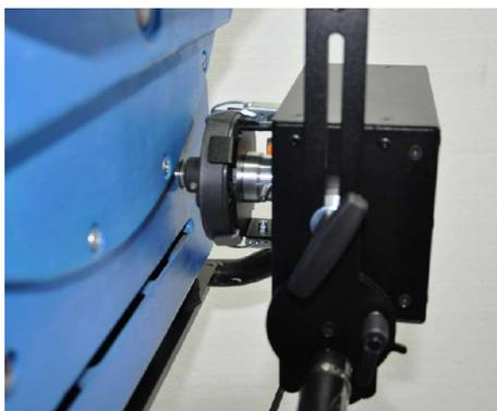
Fertig montierte Fokus-Antriebseinheit
