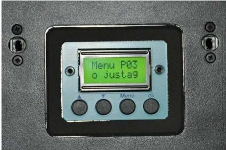
Drücken Sie **MENÜ**, wählen Sie P03 mit der **UP** und/oder **DOWN** Taste. Wenn P03 angezeigt wird drücken Sie erneut **MENÜ** um in den Menüpunkt zu gelangen.
