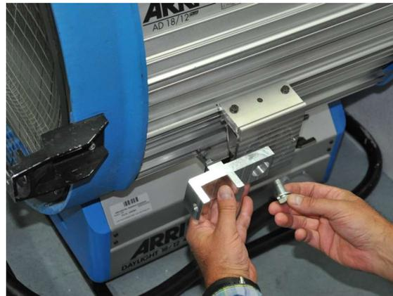
Montieren der Lampenhalter mit einer Schraube
