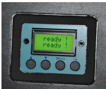
Warten Sie bis das Display „**ready**“ anzeigt. Der Motorbügel ist nun bereit für den Einbau der Lampe. Schalten Sie den Bügel aus.
