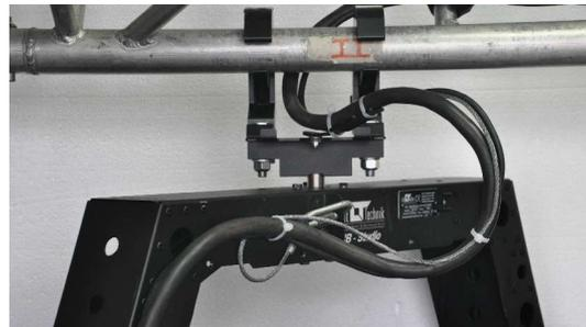
Bei falsch geführten Kabelsträngen kann es durch mechanische und thermische Einwirkung zu Knicken und Rissen in den Kabeln kommen!!
