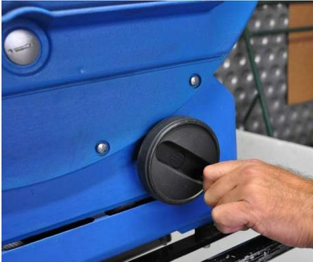
Zählen Sie die **Umdrehungen** um die ungefähre **Mittelstellung** zu finden. Verfahren Sie den Fokusschlitten per Hand auf diese Position
