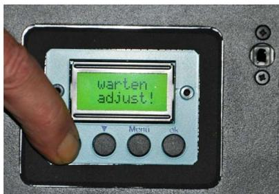
Drücken und halten Sie die **UP-Taste**. Schalten Sie das Gerät an. Das Display zeigt „warten“ und „adjust“. Lassen Sie die Taste los und **warten** Sie. Die Elektronik verfährt die Achsen inklusive Fokus auf die **Einbauposition**.
