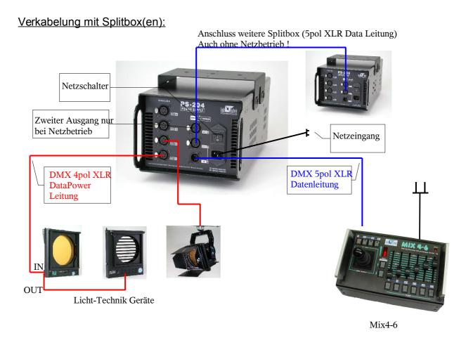
Verbinden Sie mit dem 5poligen DMX-Kabel das Lichtmischpult mit der Splitbox PS104 bzw. PS104. Unsere Splitbox hat zwei weitere DMX-Out-Buchsen (5pol) um weitere Splitboxen anschließen zu können. An jedem der vier DATA-Power-Ausgänge können Licht-Technik Geräte auch in Reihe angeschlossen werden. Beachten Sie die maximale Anzahl der Geräte pro Netzteil auf der nächsten Seite. Stecken Sie das Netzkabel ein.
