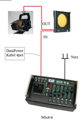
Verbinden Sie direkt die Licht-Technik Geräte mit dem Mix4-6 über das 4polige DataPower-Kabel. Stecken Sie ein Gerät an das andere. Beachten Sie auch hier die Gesamtleistung der Geräte, diese darf 120W nicht überschreiten. Der Motorbügel hat keine Ausgangsbuchse. Mit dieser Verkabelung kann daher nur ein Motorbügel betrieben werden!
